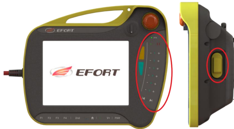
图 4-7 手压开关和点动按钮位置
