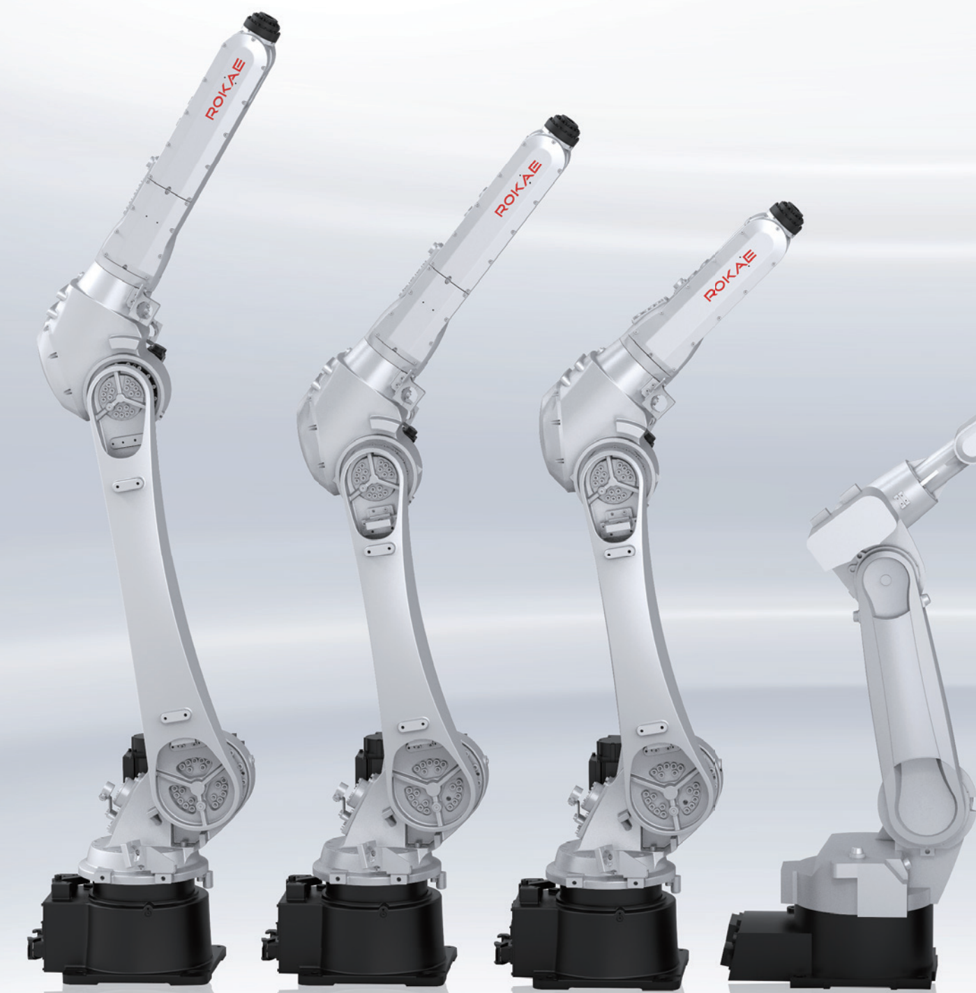
XB16 负载: 16kg 臂展: 2013mm XB20 负载: 20kg 臂展: 1813mm XB25 负载: 25kg 臂展: 1617mm XB10 负载: 10kg 臂展: 1393mm
