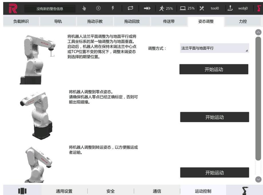
当需要调整姿态时，请确认机器人使用工况，手动模式上电，按住开始运动按钮，机器人开始执行姿态调整。当需要停止机器人时，直接松开按钮即可。
