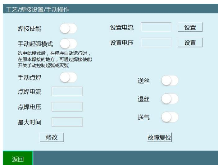
2、焊接使能打开，机器人才会执行焊接功能。
