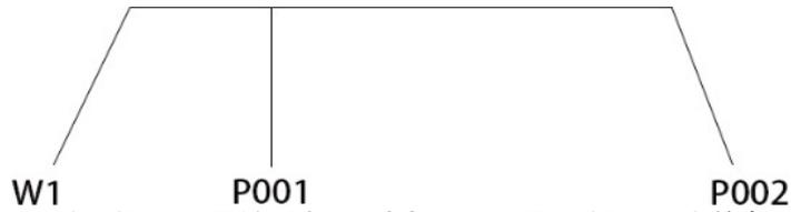
4s 就移动到 P001 时，机器人开始送气，到达 P001 后，机器人直接起弧。例如 W1 移动到 P001 需要 10s，6s 时，机器人开始送气，10s 时，到达 P001 点，同时开始起弧。
