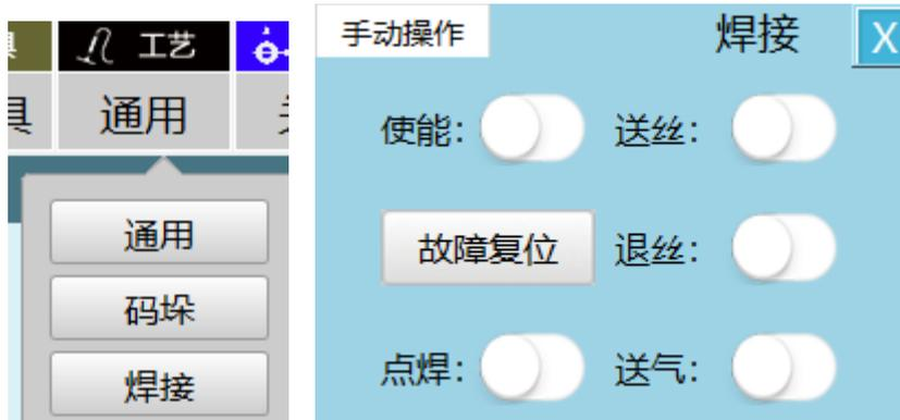
点击其中的焊接，会弹出手动操作的焊接窗口
