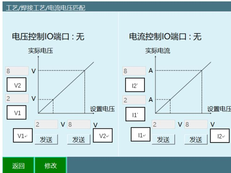
控制器发送给焊机的电压、电流与焊机实际的电压、电流是有比例关系的，把控制器和焊机连上，打开示教器界面如图所示，在 V1 处设置一个电压参数，点击发送，可以看到焊机上也会对应出现一个电压，把该电压填入 V1' 处，V2 如上操作，如此可以设置控制器上的电压，同理可以操作设置电流。
