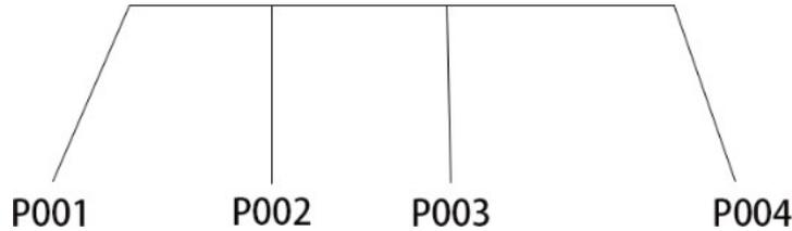
**没开启手动起弧模式：**机器人从焊接起始点 P001 在向焊接终点 P004 移动过程中，焊接使能键无效（即使打开焊接使能键，机器人也不会起弧）
