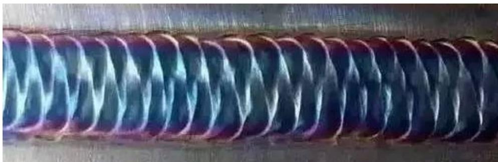
这里提供了两种摆动方式，有正弦、Z字型；摆动频率、摆动幅度、起始方向、水平偏角、竖直偏角等等不同参数可调，可根据工业现场实际需要设置。
