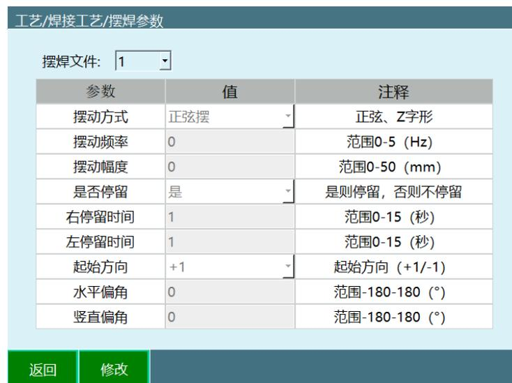
2、摆焊是焊接时，焊缝热源在焊件上进行有规律的横向摆动的焊接操作。摆焊效果图如下所示。
