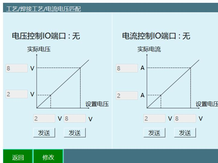
点击修改后，修改按钮变成保存，电流电压输入框变白，可以在各自的参数后面输入数值。
