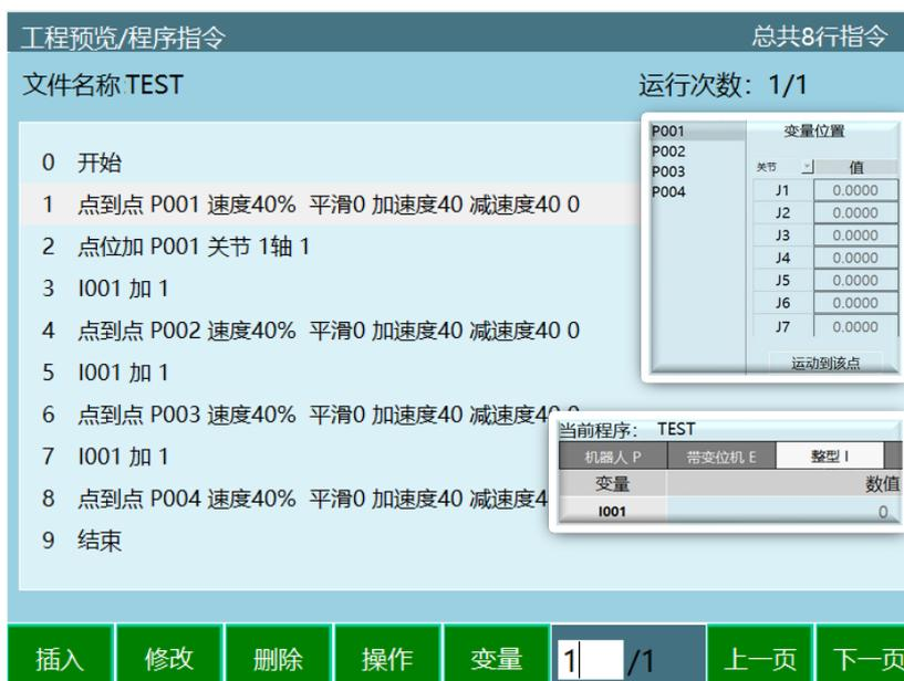
运行到第 6 行时 P001 J1=1、I001=2，切换示教模式产生断点，切换到示教模式后查看 P001、I001 显示为初始值，此时按【DEADMAN】上电，显示为 P001 J1=1、I001=2，下电恢复初始值。
