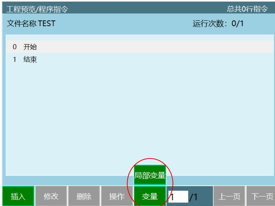
数值型变量储存的是数值，包含了整数型变量、实数型变量、布尔型变量三种。定义的所有局部数值变量都只能用于当前程序，其他程序、后台程序都无法使用。
