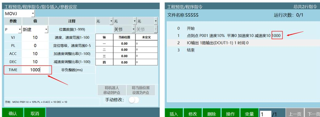
上图示例程序中，MOVJ 指令后插入 DOUT 指令；MOVJ 指令 TIME 参数填 1000ms，则运行时提前 1s 执行下一条指令，例如 MOVJ 指令会执行 3s，则 MOVJ 指令运行 2 秒执行 DOUT 并继续执行 MOVJ 到 P001。
