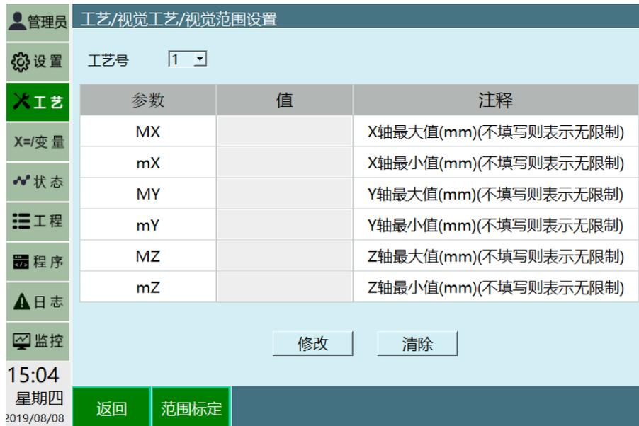
为了避免相机传递回来的地址参数超出了机器人所能达到的范围，规定了机器人所能达到的最大范围。
