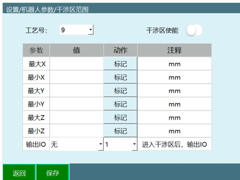
\*最大值与最小值请勿填反; 最多支持标定 9 个干涉区同时使用。
