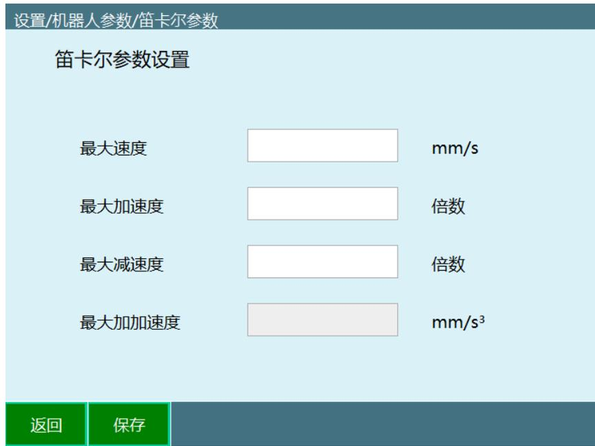
设置/机器人参数/笛卡尔参数
