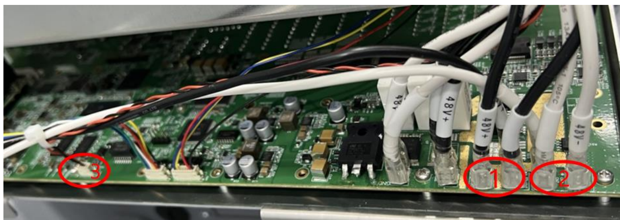
图 3-28 Safe IO 上的线缆位置
