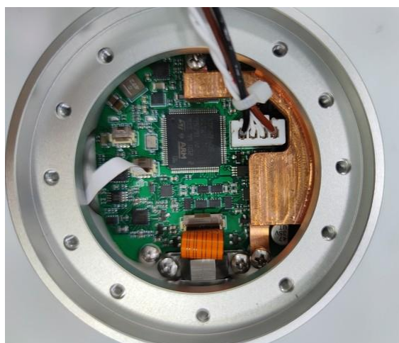
图 3-17 连接手腕 3 关节和末端法兰的电线
