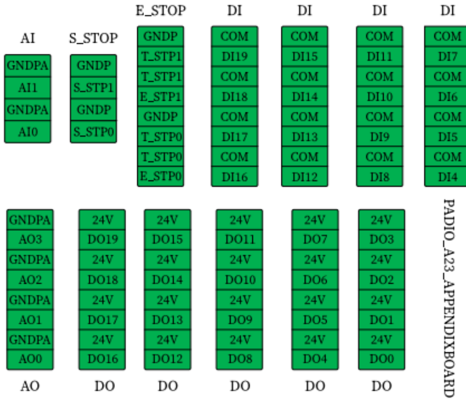
图 7-2：控制箱内部电气接口布局
