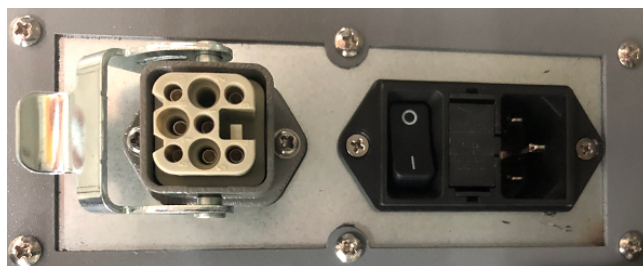
图 4-5 ：控制箱底部开关电源
