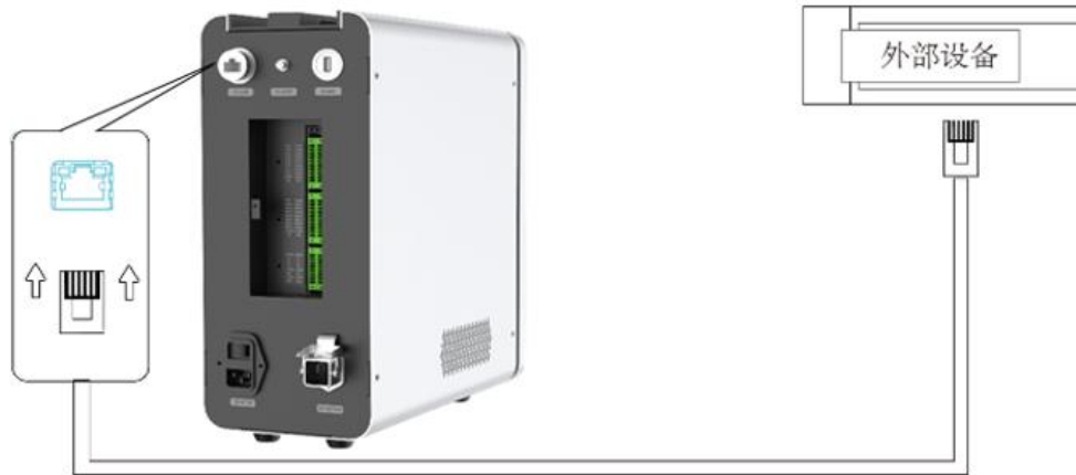
图 3.57 Dobot 机器人控制系统与外部设备直连
